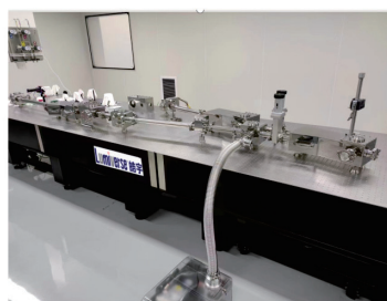
(鸞鷟:鸞鷟EUV光源与束线系统无缝集成,提供10-100 nm波长范围的高精度光束控制和输出,支持窄谱线EUV激光输出。)
